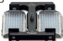
Swing out rotor 2 x Microtitre plates
